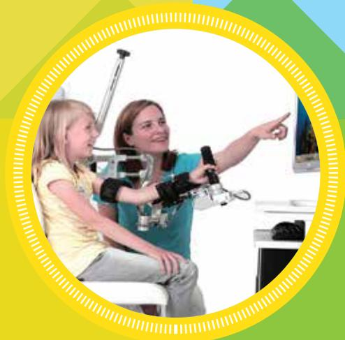
Por otro lado *Amadeo*, creado en Austria alrededor del año 2005, es el robot de la mano, muy útil para rehabilitar los movimientos de flexión y extensión de los dedos..
